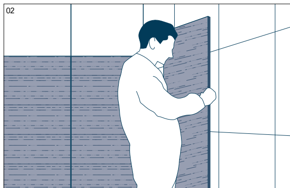
Posa di un cartone protettivo sulla parete posata.
